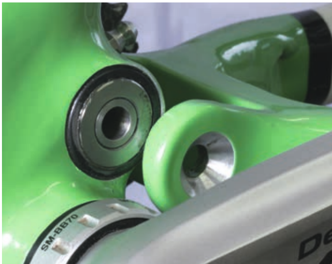
Bild 3: Durch O-Ringe werden die wartungsfreien Gelenklager vor Verschmutzungen geschützt
