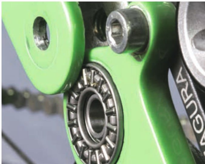
Bild 1: Die Kombination des wartungsfreien Gelenklagers mit dem darüber liegenden Axialnadelkranz führt zur gewünschten Steifigkeit bei gleichzeitiger radialer Stoßlastaufnahme.
