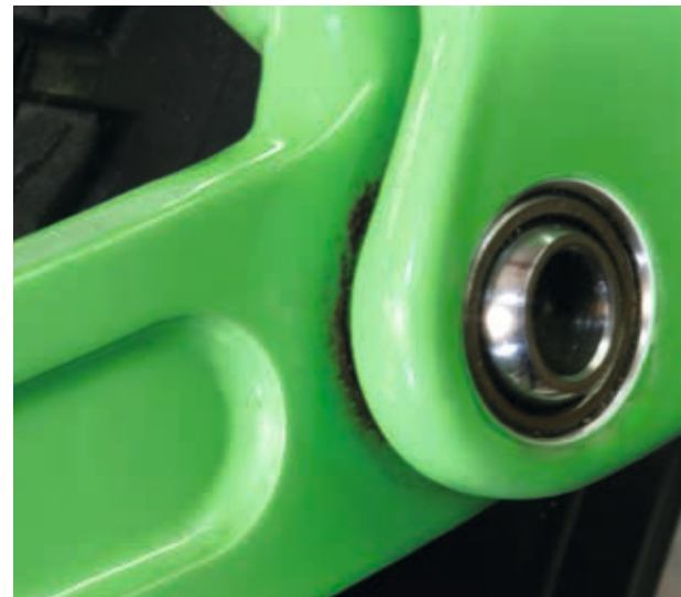
Bild 2: Die Gelenklager für die Federung des Hinterrads nehmen eine hohe Stoßlast auf.
